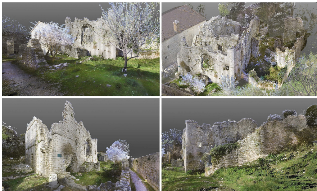
Fig. 5 Stari Bar, il Palazzo del Doge: rilievo con laser scanner 3D e costruzione della nuvola di punti (da CARDACI, VERSACI 2016, fig. 2d).
